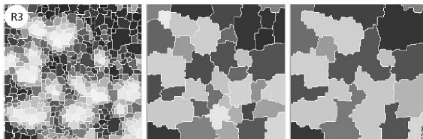
ภาพที่ 2.1 การแยกและการรวมพื้นที่ (de Jong and van der Meer, 2004)
