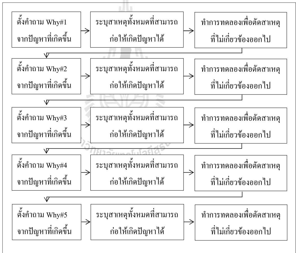
รูปที่ 3.2 แผนผังแสดงการวิเคราะห์จุดเสียโดยวิธีตั้งคำถาม 5 Whys
