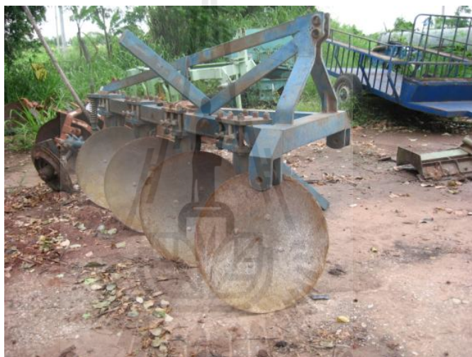
รูปที่ 3.6 อุปกรณ์ตัดพวงรถแทรกเตอร์ชนิดผาล 4
