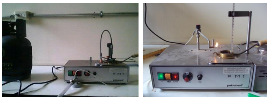
รูปที่ 3.10 เครื่องมือทดสอบจุดวาบไฟและจุดติดไฟ
