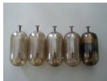
รูปที่ 3.13 การนำ Glass Coking Bulb ออกจากเตาเผามาใส่ตู้ดูดความชื้น หมายเหตุ การใช้ Glass Coking Bulb ควรใช้เพียงครั้งเดียวไม่ใช่ซ้ำ
