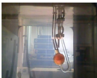
รูปที่ 3.6 การนำหลอดแก้วรูเล็กประกอบกับขาช็อค และแช่ลงในอ่างน้ำควบคุมอุณหภูมิ
