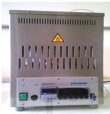
รูปที่ 3.12 เครื่องมือวิเคราะห์กากคาร์บอนตกค้าง แบบ Rambottoms ขั้นตอนการวิเคราะห์มีดังนี้
