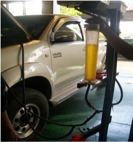
รูปที่ 3.15 อุปกรณ์วัดอัตราการสิ้นเปลืองเชื้อเพลิง และการต่อสายน้ำมันเข้ากับปั๊มและเครื่องยนต์
