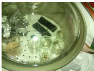
รูปที่ 3.13 การนำ Glass Coking Bulb ออกจากเตาเผามาใส่ตู้ดูดความชื้น หมายเหตุ การใช้ Glass Coking Bulb ควรใช้เพียงครั้งเดียวไม่ใช่ซ้ำ
