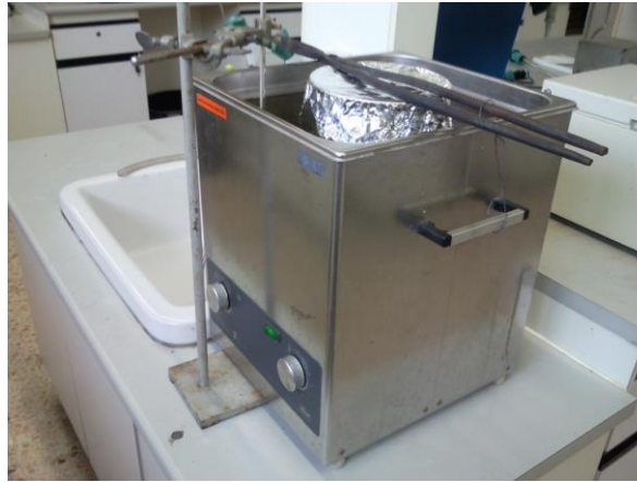
รูปที่ 3.4 การผสมน้ำมัน โดยใช้เครื่องเขย่าระดับโมเลกุลเป็นเวลา 15 นาที ที่อุณหภูมิ 35°C
