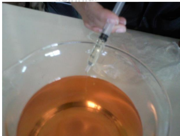
รูปที่ 3.3 การผสมสารเติมแต่งเข้าไปในน้ำมันดีเซล และน้ำมันปาล์ม โดยใช้ กระบอกฉีดยาตวง
