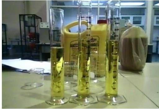
รูปที่ 3.8 การตรวจสอบสารใส่กระบอกตวงก่อนที่จะนำไปใส่เครื่องมือทดสอบความถ่วงจำเพาะ
