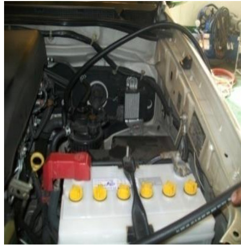
รูปที่ 3.15 อุปกรณ์วัดอัตราการสิ้นเปลืองเชื้อเพลิง และการต่อสายน้ำมันเข้ากับปั๊มและเครื่องยนต์
