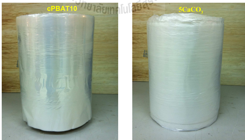
รูปที่ 3.12 แสดงตัวอย่างฟิล์มที่ได้จากการขึ้นรูปด้วยการเป่า
