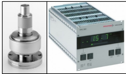
รูปที่ 3.10 เซนเซอร์ และ อุปกรณ์อ่านค่าความดันสุญญากาศ
