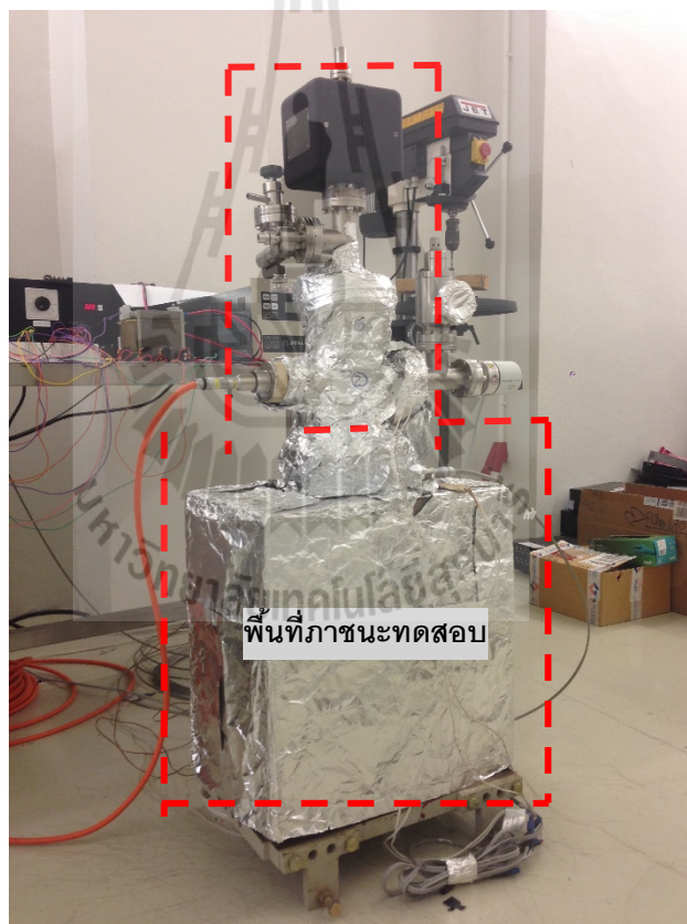
รูปที่ 5.5 ภาชนะที่ใช้ทำการทดสอบขนาดประมาณ 71 ลิตร
