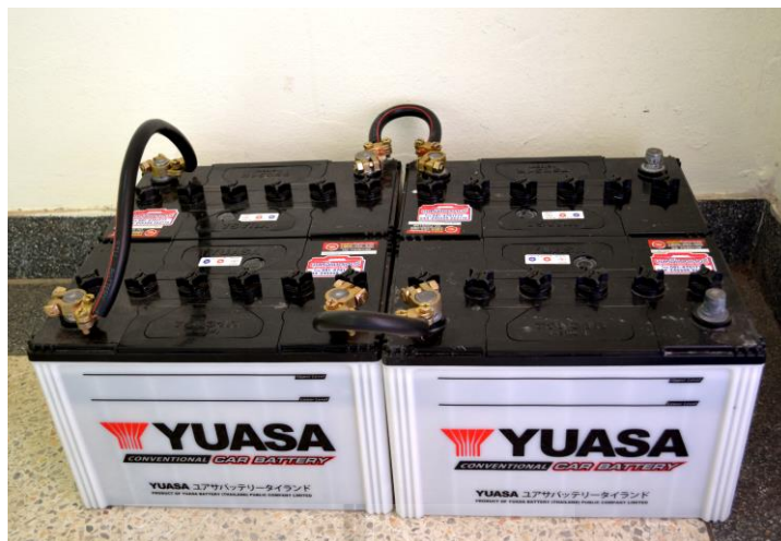
รูปที่ ข.3 แบตเตอรี่ที่พิกัดแรงดันเท่ากับ 12 V และมีขนาดการประจุพลังงานที่เท่ากับ 75 Ah ต่ออนุกรมกัน 4 ลูก เพื่อเพิ่มระดับให้เป็น 48 V
