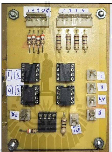
รูปที่ 3.23 วงจรแยกโคคสัญญาณที่สร้างจริง
