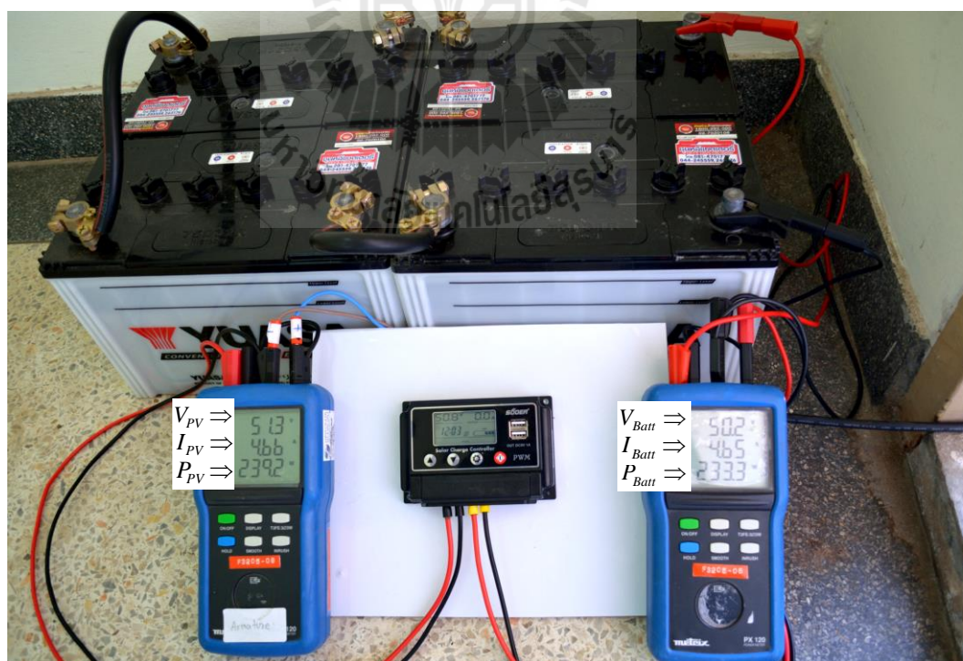
รูปที่ ข.4 การวัดกำลังงานไฟฟ้าอินพุต และเอาต์พุตของเครื่องควบคุมการชาร์จประจุ
