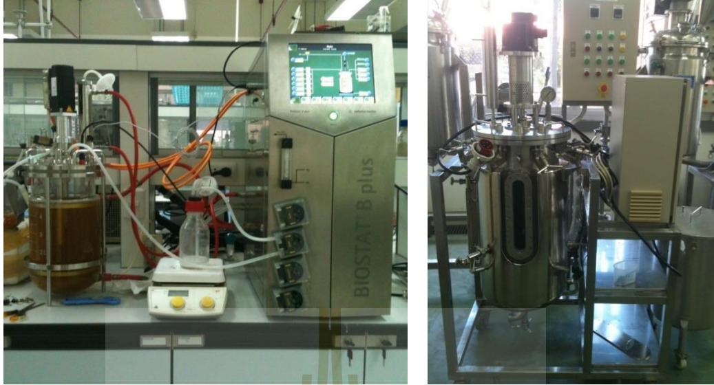
รูปภาพ 24 การเตรียมกล้าเชื้อในถังหมักขนาด 5 ลิตรและกระบวนการหมักกรดซัคซินิกแบบกะในถังหมักขนาด 40 ลิตร
