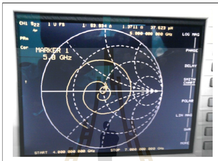
รูปที่ 4.8 ผลการวัดทดสอบค่าอิมพีแดนซ์ของช่องว่างแถบความถี่แม่เหล็กไฟฟ้าร่วมกับไดโพลพับต้นแบบ
