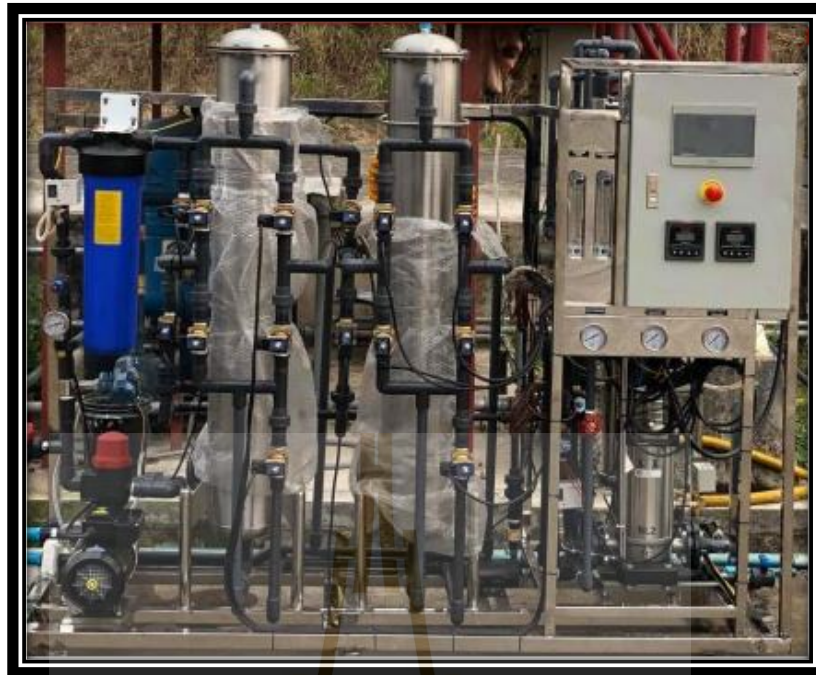
รูปที่ 4.17 เครื่องกรองน้ำโดยใช้เทคนิคการรีเวิร์สออสโมซิสแบบผันกลับร่วมกับระบบปรับปรุงคุณภาพน้ำบน PLC และ HMI
