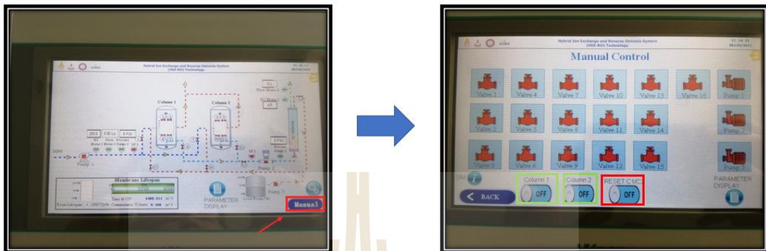
รูปที่ 4.5 หน้าต่างการทำงานด้วยโหมด Manual
