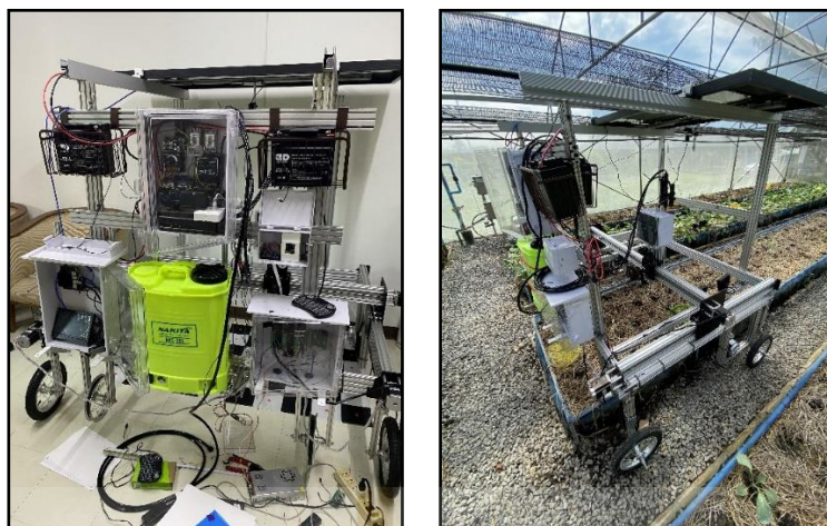
รูปที่ 3.11 อุปกรณ์ควบคุมที่มีกล่องควบคุมรองรับที่ด้านหลังของเครื่อง
