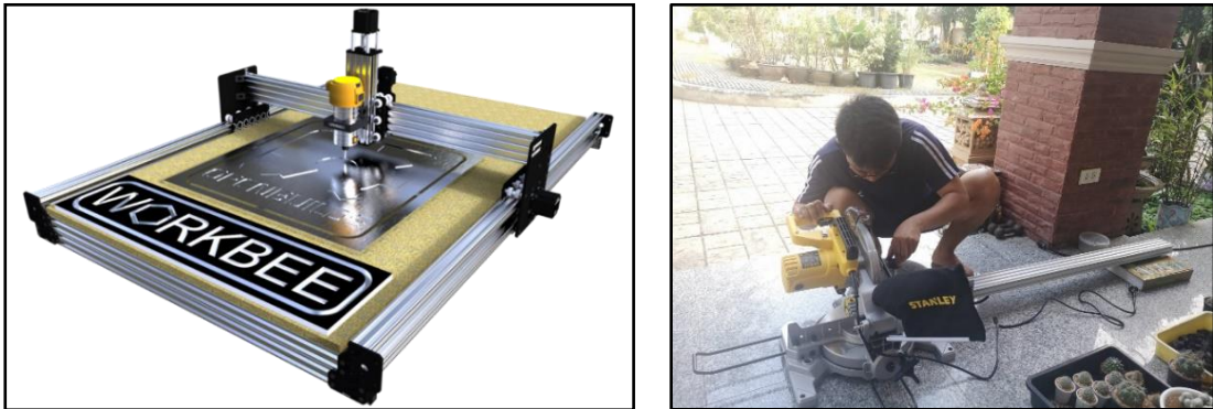
รูปที่ 3.8 โครงสร้างเครื่องซีเอ็นซีของ WorkBee และการใช้อะลูมิเนียมโปรไฟล์มาขยายขนาด
