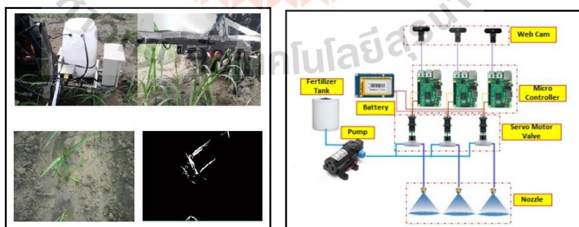
รูปที่ 2.2 Image segmentation systems and diagram of variable rate fertilizer sprayer (ที่มา : ไชยยันต์ สิริกุล และเกรียงไกร แซมสีม่วง, 2021)
