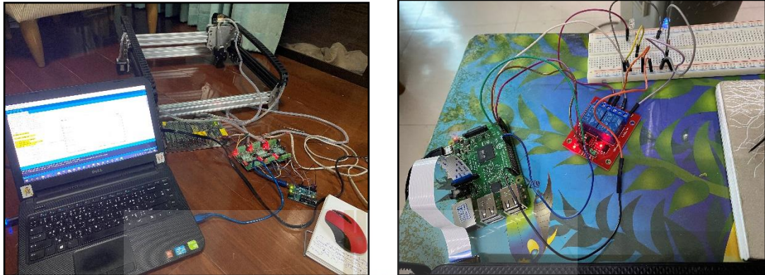
รูปที่ 3.32 การเขียนโปรแกรมควบคุมที่แยกส่วนไปตามบอร์ดควบคุม
