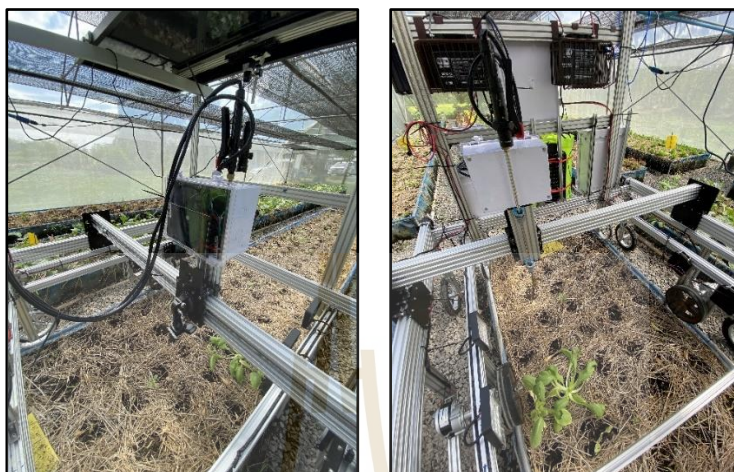
รูปที่ 3.10 กลไกการฉีดพ่นปุ๋ยที่ติดตั้งในโครงสร้างของเครื่อง
