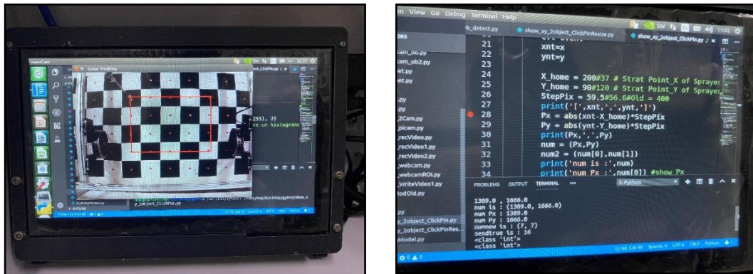
รูปที่ 3.22 ชุดคำสั่งและการแสดงผลจากการประมวลผลภาพเพื่อกำหนดพิกัดวัตถุในภาพ
