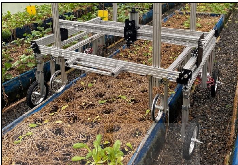
รูปที่ 3.7 โครงสร้างของหุ่นยนต์ที่ติดตั้งเพื่อเคลื่อนที่บนแปลงปลูก
