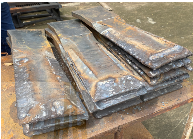
รูปที่ 1.1 แสดงใบมีดสับอ้อยที่ผ่านการเชื่อมซ่อมด้วยกระบวนการเชื่อม MIG
