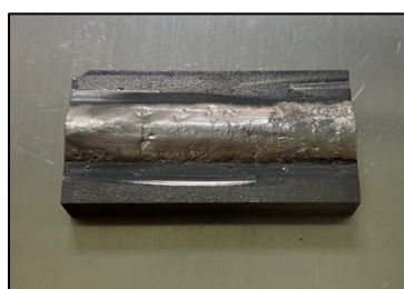
รูปที่ 3.32 ชิ้นงานสำหรับการทดสอบการสึกหรอของชิ้นงาน
