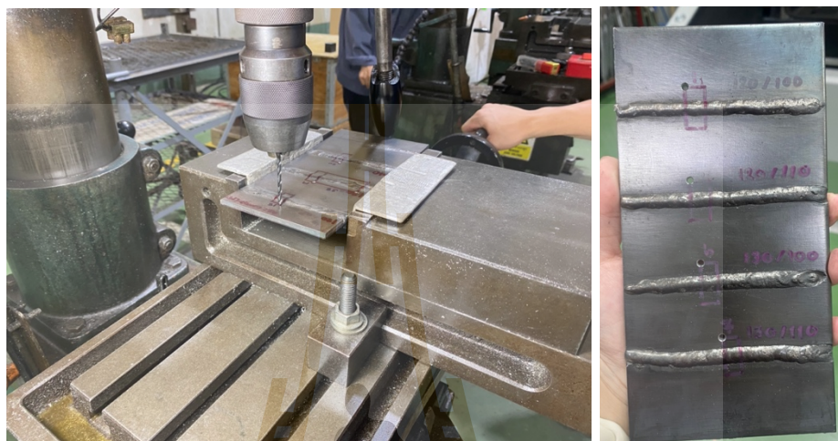
รูปที่ 3.22 ชิ้นงานที่เจาะด้วยเครื่องเจาะแนวตั้ง
