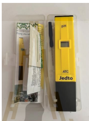
รูปที่ 3.12 เครื่องวัดกรด-ด่าง (pH) แบบปากกา Jedto
