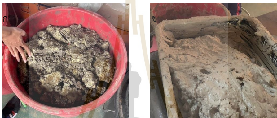
รูปที่ 3.4 ลักษณะดินตัวอย่าง ก) ดินอย่างที่ได้เก็บจากแหล่งตัวอย่าง ข) ดินตัวอย่างที่ถูกרבกวนโดยสมบูรณ์
